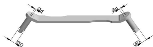
Celownik do płyt kompresyjnych otwory samodociskowe Drill guide for compression plates self-compressing holes
